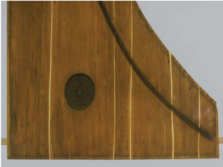
Abb. B.103: Der Resonanzboden des Cembalos von J. Salodiensis, Salo 1559, (Inv.-Nr. SAM 630) wies 1990 vor der Restaurierung 64 Schwundrisse auf. Die Rissbildung wurde durch (im 19. Jahrhundert) darunter geleimte Rippen forciert. Es mussten 15 mm Schwund kompensiert werden. Zypressenholz im Tangentialschnitt ist für Druckschwund besonders anfällig.
