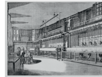
Abb. 89: Wirker am haute-lisse-Wirkstuhl (aus Diderots Enzyklopädie).
