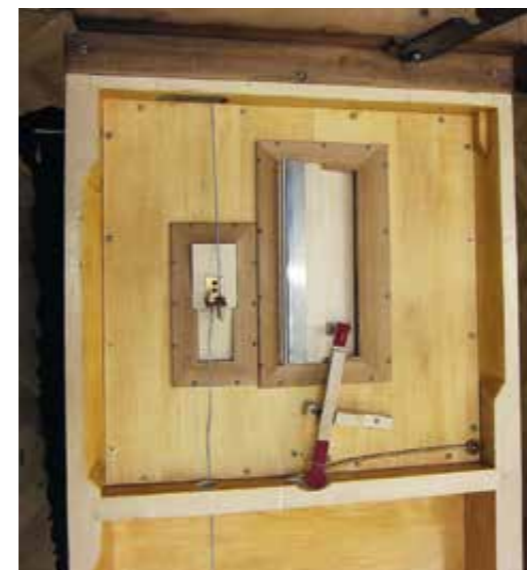
Harmonium SAM1218: Der nachgebaute Windkasten mit der Expression-Steuerklappe
