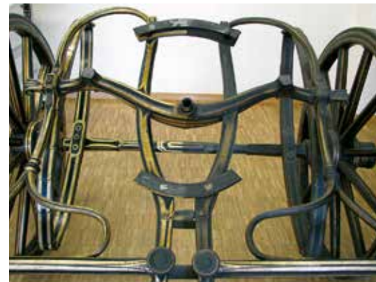
Barouche der Fürsten Schwarzenberg: Fahrgestell während der Reinigung
