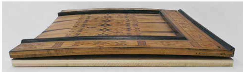
Der durch Schwund deformierte Deckel des Spinetts Inv.-Nr. SAM 119
