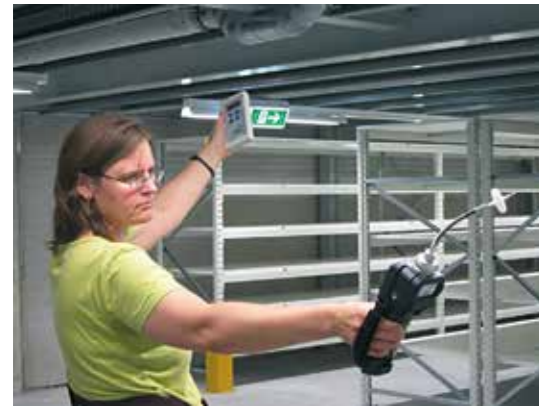
Dr. Martina Griesser bei der Messung von Luftschadstoffen im neuen Zentraldepot Himberg. (Foto: Christina Schaaf-Fundneider)
