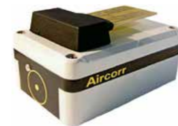
Der im Depot verwendete Datenlogger AIRCORR I (© MUSECORR Projekt, http://www.musecorr.eu/ ), Abb. entnommen aus dem Vortrag von Tomas Prosek, AirCorr corrosion monitoring system: Description, sensitivity, reproducibility and accuracy , IAQ London, 18.-20.6.2012)
